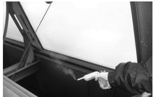
스모크 건을 이용한 기류 확인
