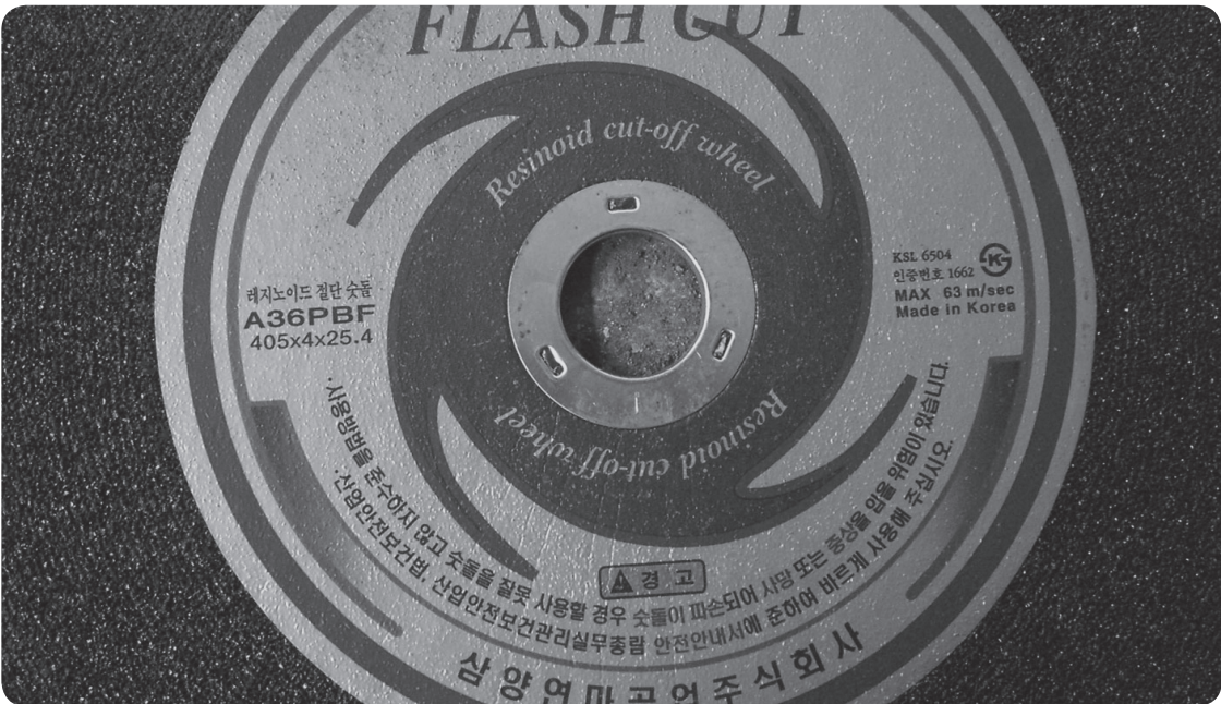
사진 4 16인치 절단숫돌에 표시된 규격 및 경고 문구
