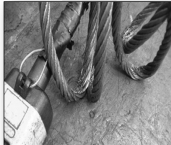
크레인 달기구 와이어로프 손상피단
