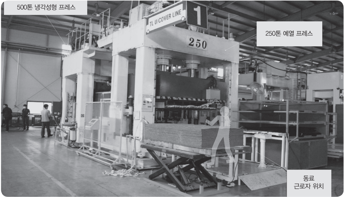
사진 1 재해발생 공정 전경(소재 투입 장소, 250톤 예열 프레스)
