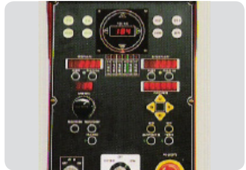
전환스위치 키 제거 후 전환 불가능 여부 확인 (비밀번호 설정의 경우 임의 전환 불가능 여부 확인)
