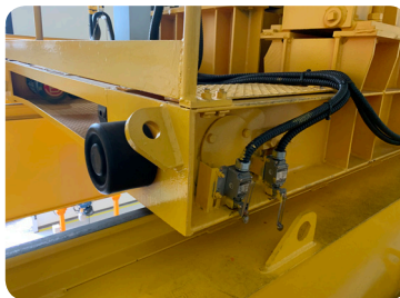
횡행레일 리미트스위치 (크레인 상부) 설치 여부확인 (지상) 성인의 빠른 걸음 속도 (66m/min)와 비교하여 확인.
