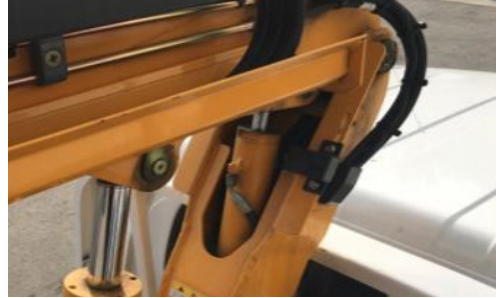
• 기복 실린더의 근접센서 타입 - 기복 실린더가 인출되어 근접센서가 감지되지 않는 상태에서 아웃트리거 작동여부 확인
