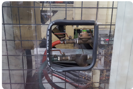
조작밸브가 보호영역 내부에 있으나 보호영역 외부에서 안전한 조작이 가능한 구조이므로 인정가능
