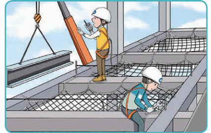
6 안전대 착용 시 안전대 부착설비 설치
