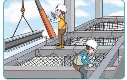
6 안전대 착용 시 안전대 부착설비 설치
