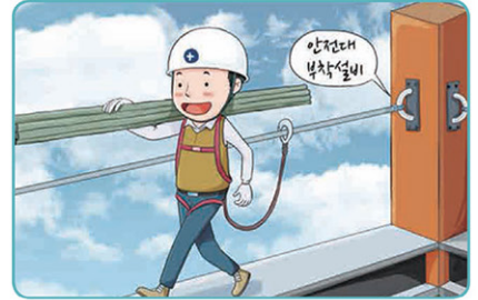
6 안전대 착용 시 안전대 부착설비 설치
