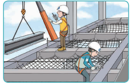
6 안전대 착용 시 안전대 부착설비 설치
