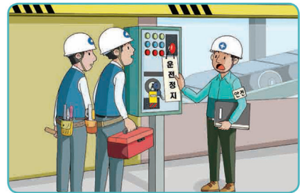
3 기동장치 잠금조치, 표지판 설치
