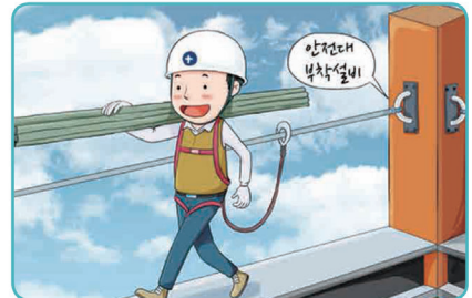
6 안전대 착용 시 안전대 부착설비 설치
