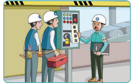
3 기동장치 잠금조치, 표지판 설치
