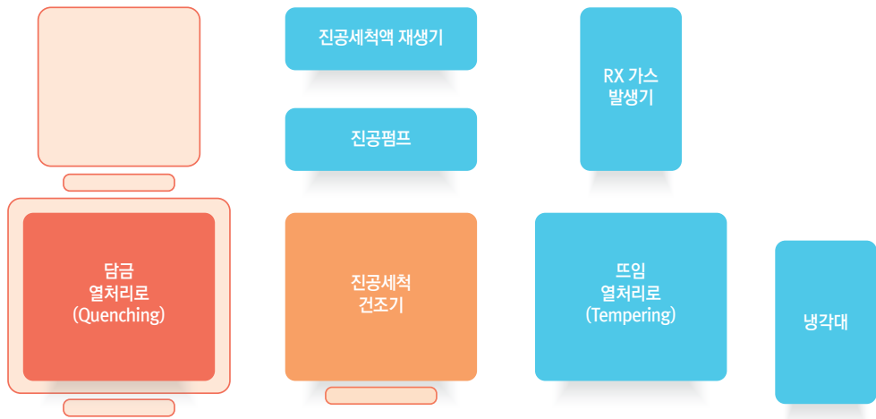
그림 5 배치 (Batch) Type 열처리로 구성
