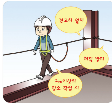
안전대 및 부착설비 설치
