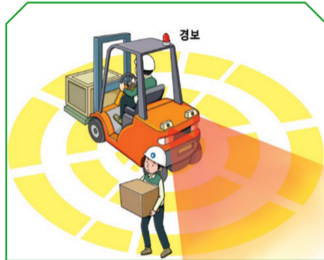
차량계 건설 및 하역운반기계 스마트 안전장치 (충돌방지장치)
