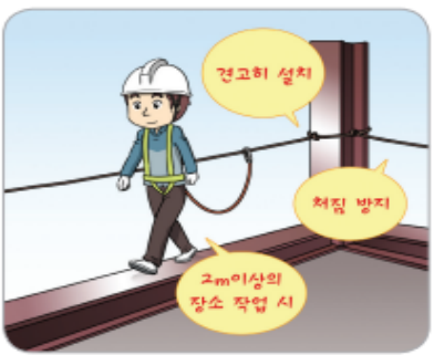
안전대 및 부착설비 설치
