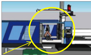
재해자가 사출성형기 내부에 대기한 상태
