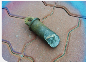
샤클핀 균열 파손
