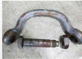
샤클 본체 파손
