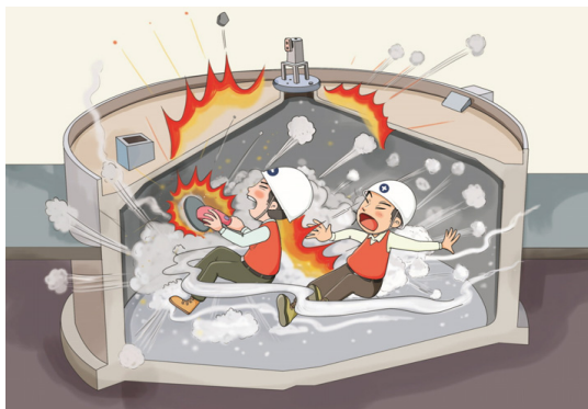
- 하수처리시설 내 인화성가스로 폭발위험 분위기가 조성된 장소에서 전기기계기구를 사용하여 폭발 2명 사망
