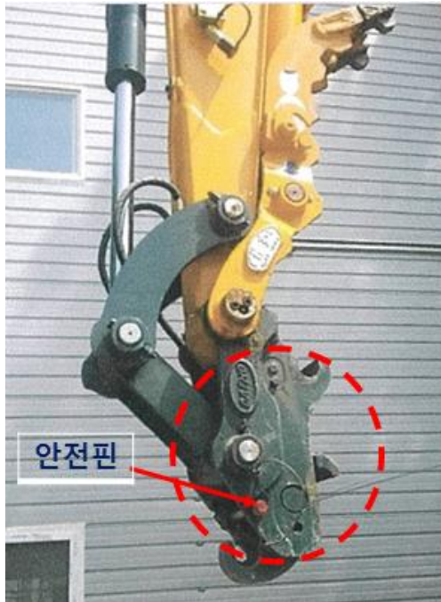
<그림 9> 퀵 커플러 안전핀 설치 상태
