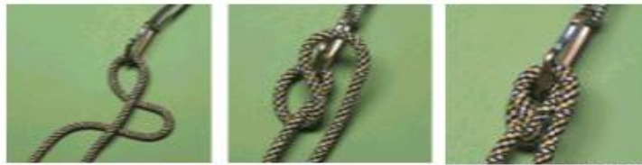
<그림 6> 반(半) 까베스탕 매듭 결속방법(2)
