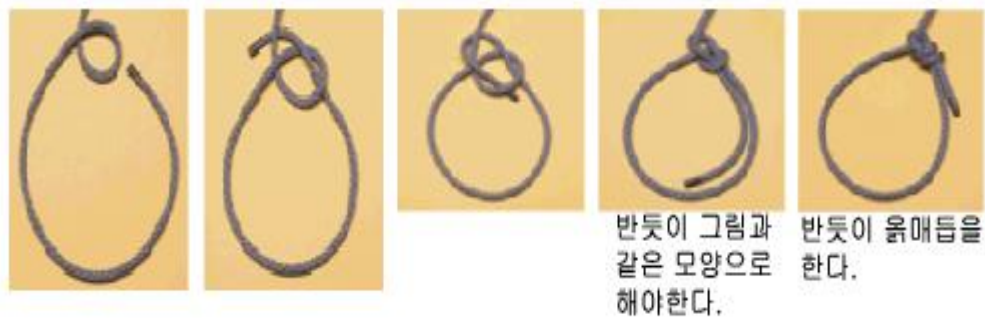
<그림 2> 보울라인 매듭 결속 방법
