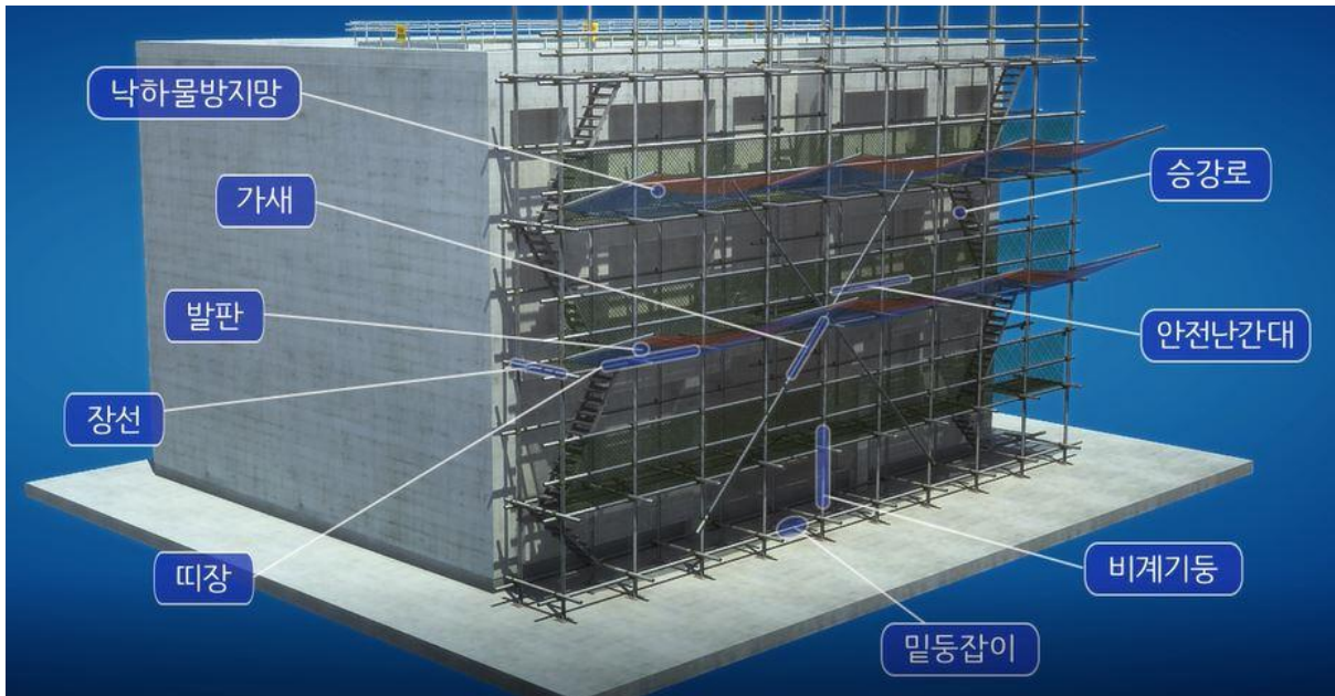
<그림 1> 강관비계의 조립 모식도
